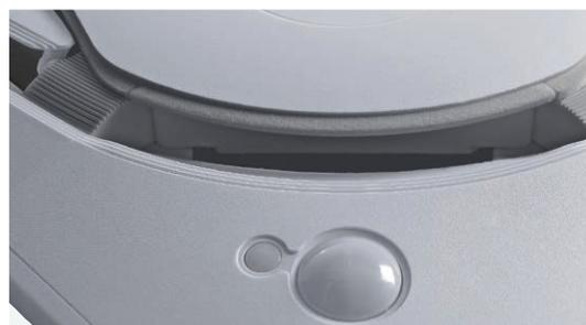
Das „intelligente Auge“, bestehend aus Infrarot-Anwesenheitssensor (links) und Infrarot-Bodensensor (rechts)
